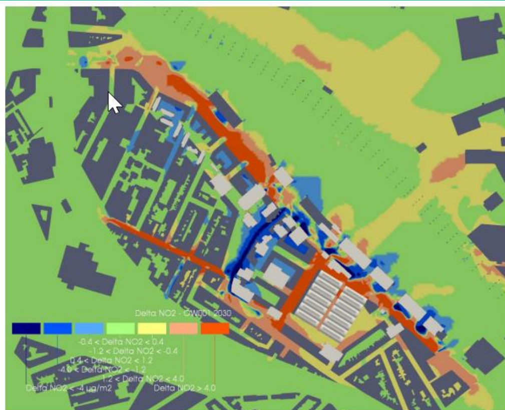
Figuur 42 : Verschilkaart van de NO 2 jaargemiddelde concentraties voor 2030 in het ow001 scenario. Afgebeeld is het verschil in absolute NO 2 concentraties tussen de situatie met de ontwikkeling en zonder de ontwikkeling. De contouren van de gebouwen na ontwikkeling zijn in donker grijs afgebeeld, de gebouwen zonder ontwikkeling in lichtgrijs. De kleurschaal komt overeen met het significantiekader van Tabel 11.
